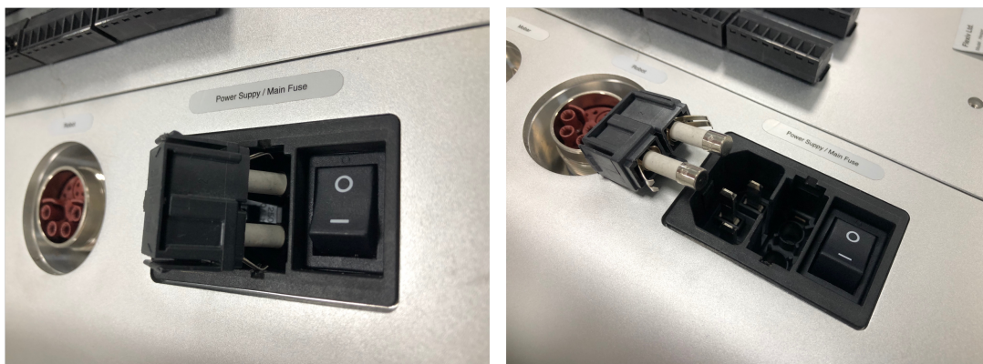
图 8.1: 交流电筒式熔断器拉出以供维护时的示例图片
